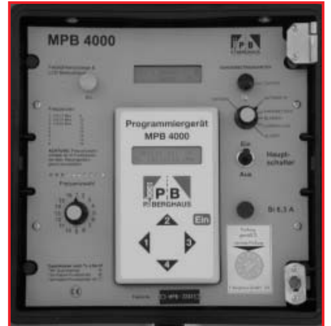
In der Steuereinheit befinden sich links die Feldstärkenanzeige und der Drehschalter für die Anwahl der verschiedenen Frequenzen
