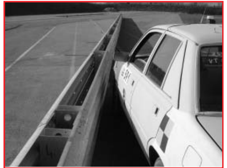
Anfahrtstest Pkw für die Prüfung TB 21 bei der L.I.E.R. in Lyon
