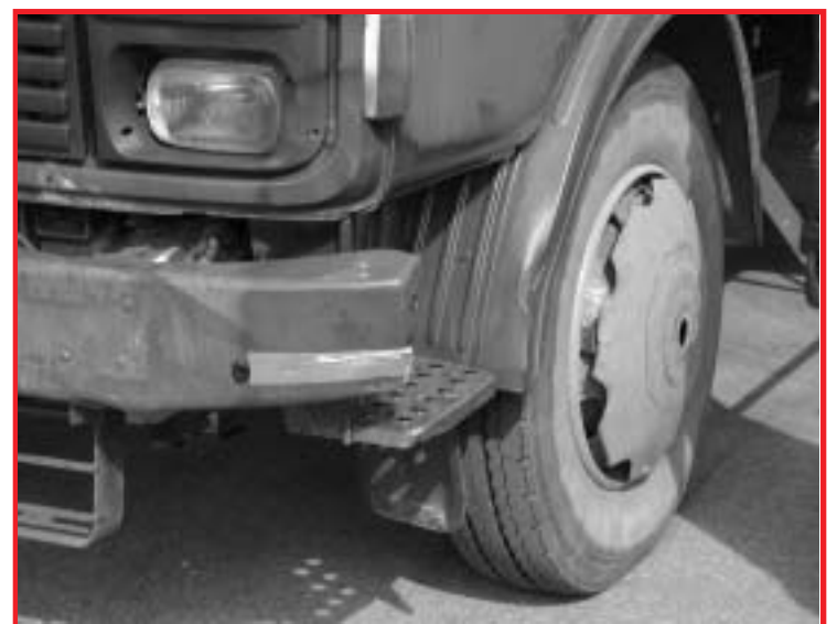
Beim Anprall entstanden lediglich geringfügige Blechschäden
