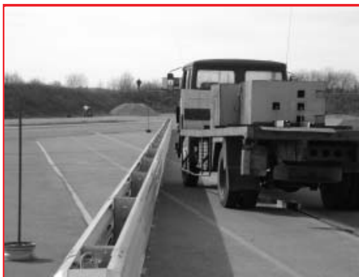
Anfahrtstest Lkw für die Prüfung TB 41 bei der L.I.E.R. in Lyon
