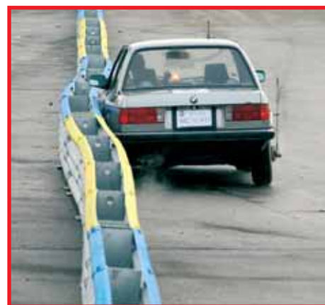
Unverankert T3-getestet: Schutzwandsysteme ProTec120 (l.) und Quadro T3 / W3
