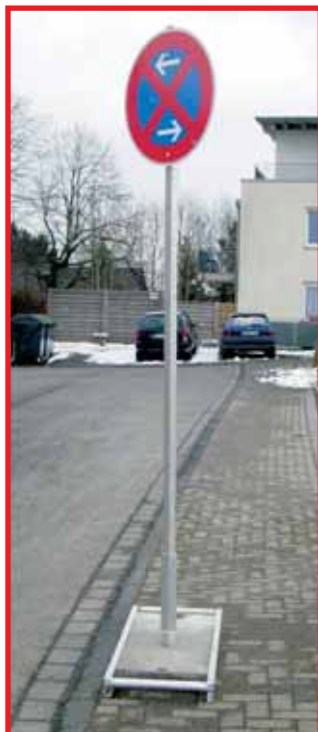
Die neue Fundamentplatte mit Aufnahme für ein 100 mm Rundrohr (RSA-Tafelsystem), Öffnungen 40x40 mm und 60x60 mm für Schaftrohre und einer 50x50 mm Aufnahme für eine Verstrebung (RSA-Tafelsystem) sowie einer speziellen um 45° Grad gedrehten Schaftrohröffnung: So steht die Fundamentplatte längs zur Fahrbahn, aber das Verkehrszeichen ist optimal in Richtung der Fahrbahn um 45° gedreht. (Abb. rechts)
