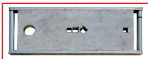
Die neue Fundamentplatte mit Aufnahme für ein 100 mm Rundrohr (RSA-Tafelsystem), Öffnungen 40x40 mm und 60x60 mm für Schaftrohre und einer 50x50 mm Aufnahme für eine Verstrebung (RSA-Tafelsystem) sowie einer speziellen um 45° Grad gedrehten Schaftrohröffnung: So steht die Fundamentplatte längs zur Fahrbahn, aber das Verkehrszeichen ist optimal in Richtung der Fahrbahn um 45° gedreht. (Abb. rechts)
