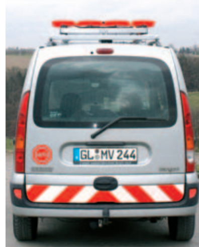
Superflacher LED-Leuchtpfeil L15 zur Absicherung der Arbeitsstelle auf neuer kompakter Hebe- und Senkvorrichtung. Beim Einschalten des Leuchtkreuzes, Pfeil links vorbei oder Pfeil rechts vorbei, richtet sich der LED-Leuchtpfeil mit seinen 15 Leuchten automatisch auf.
