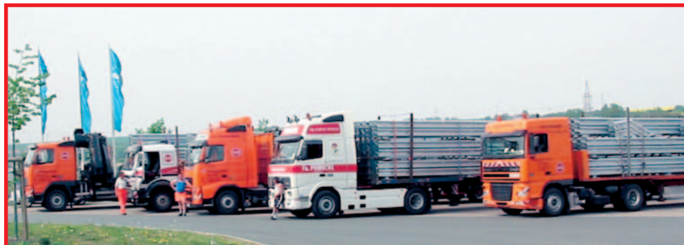
Auf Spezialtransportern werden vorgefertigte 16-m-Längen zur Baustelle transportiert
