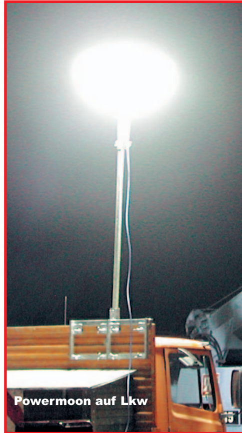
Powermoon auf Lkw BAST-geprüft: Die horizontale Nennbeleuchtungsstärke gemäß ZTV-SA wird erfüllt
