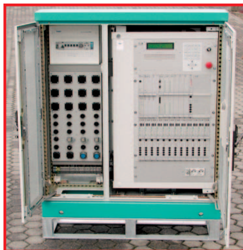
Steuergerät Master EPB 48 Multiprozessor zur Steuerung von bis zu 24 Signalgruppen, Bauvariante zur direkten Versorgung von 24 voll überwachten Signalgebern sowie Ansteuerung von mehreren Mastverteilern (Slave EPB 48)
