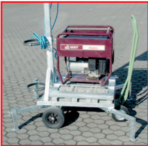
Generator auf statisch geprüfem fahrbarem Untergestell mit Deichsel
