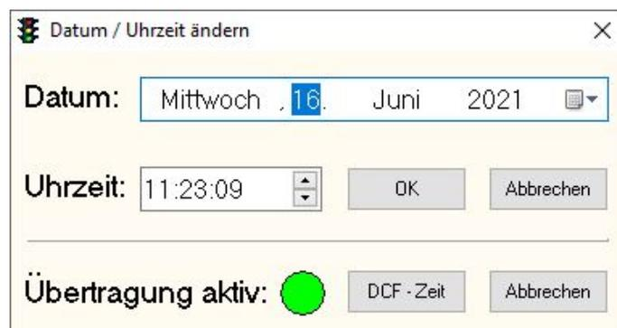
Im Feld „Datum“ kann der markierte Wert über die Pfeiltasten „auf / ab“ verändert werden. Mit den Pfeiltasten „links / rechts“ wird innerhalb des Feldes die Auswahl gewechselt. Klickt man mit der linken Maustaste auf den Pfeil nach unten, öffnet sich der Kalender zur freien Auswahl des Datums.
