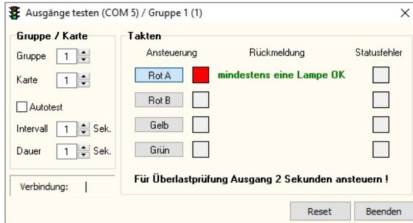
Wird eine Gruppe angetaktet, leuchtet die entsprechende Leuchte bei Status. Zusätzlich erfolgt noch eine Lampenüberprüfung der angeschlossenen Signalgeber.
