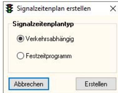
Je nach Bestätigung werden dann die Signalzeitenpläne automatisch erstellt. Bei Erstellung der Signalzeitenpläne als verkehrsabhängiges Programm wird immer eine Sekunde vor Grünende ein Dehnpunkt gesetzt. Die Zeitlückenvorgabe beträgt 5 Sekunden.
