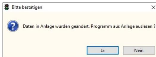
Je nach Bestätigung wird die entsprechende Funktion zum Auslesen des Programms aus der Steuerung aufgerufen.
