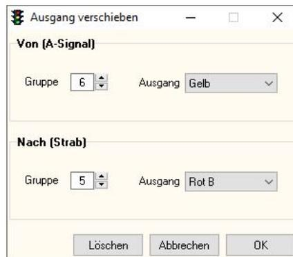
Im oberen Feld „**Von**“ wird die gewünschte Gruppe ausgewählt und bei Ausgang der Lampenausgang eingestellt, der verschoben werden soll.
