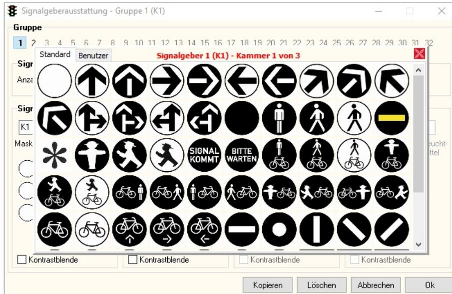
Klickt man mit der linken Maustaste auf eines der Symbole, wird dieses als Symbol für die entsprechende Signalgeberkammer verwendet. Zur besseren Orientierung werden im Auswahlfeld immer der aktive Signalgeber und die entsprechende Kammer eingeblendet.
