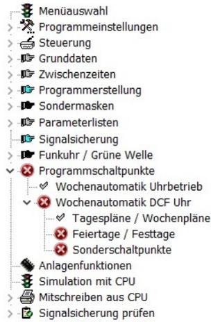
Die Steuerung führt dann diesen Schaltwunsch nicht aus und verbleibt im aktuellen Programm bis wieder ein gültiger Schaltwunsch vorliegt. In den jeweiligen Eingabemasken werden diese Einträge farblich markiert.
