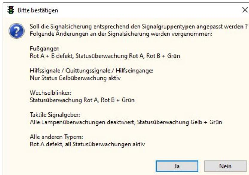
Je nach Bestätigung werden den entsprechenden Einstellungen in der Signalsicherung, für alle Signalgruppen vorgenommen. Bereits vorgenommene Einstellungen werden geändert. Die Signalsicherung ist auf Vollständigkeit zu überprüfen!
