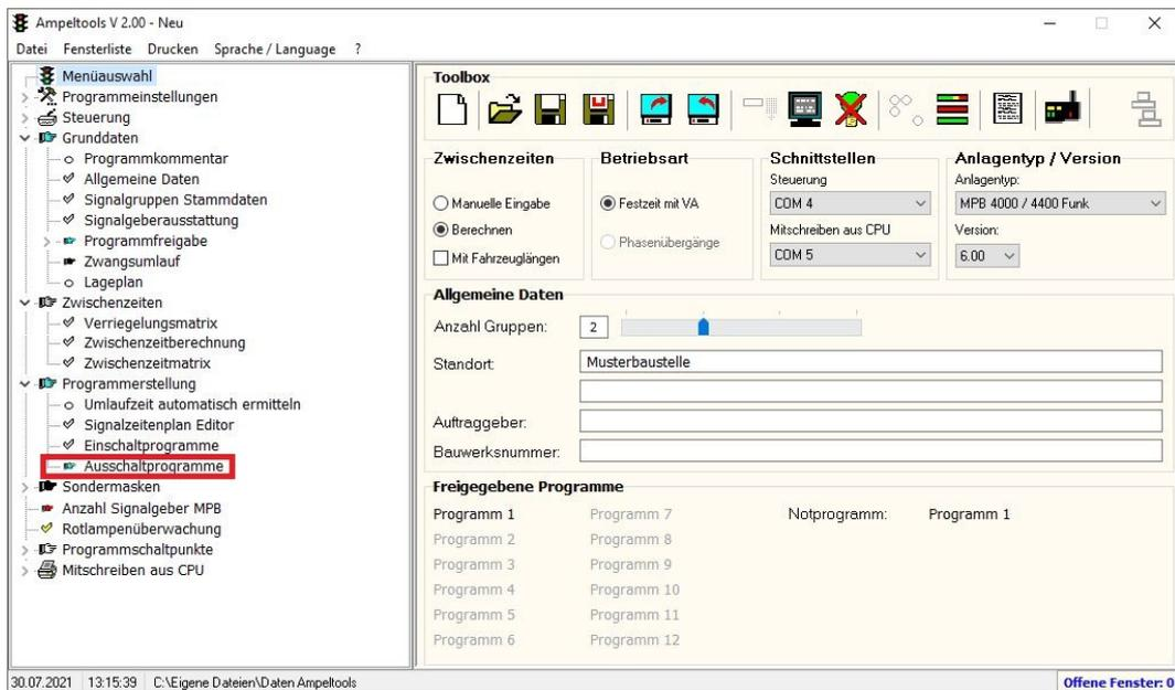
Als Schrittdauer geben Sie bitte den höchsten Wert aus der Zwischenzeitmatrix ein, der Ihnen bei „Höchste Zwischenzeit aus Matrix“ angezeigt wird. Die beiden anderen Schritte bleiben leer. In der RiLSA 2015 gibt es keine definierten Ausschaltbilder für Engstellensignalanlagen, es wird nur ein Beispiel gezeigt wie man über Allrot abschalten könnte. Hier ist eventuell eine Absprache mit der anordnenden Behörde erforderlich, ggf. muss dann der Ausschaltpunkt angepasst werden.
