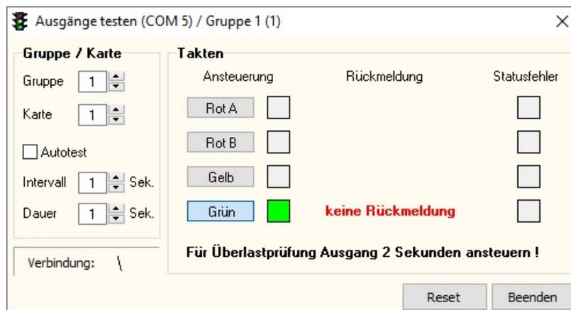
Zusätzlich wird noch jeder Ausgang auf Statusfehler überprüft.
