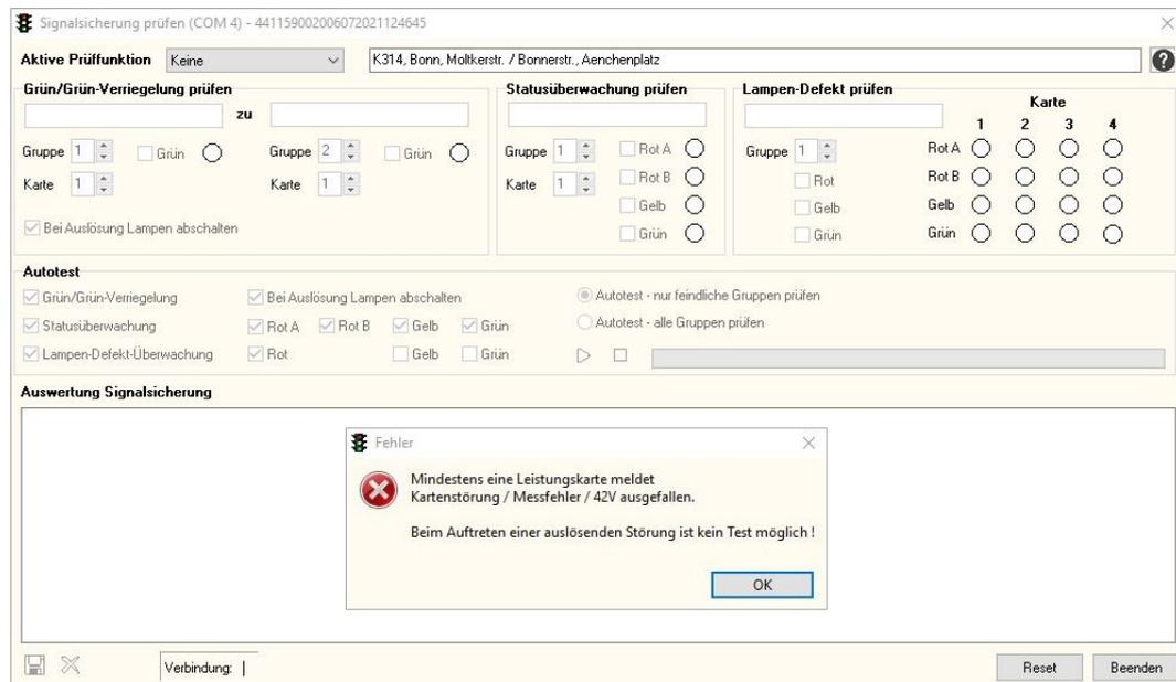
Wird bei der aktuellen Versorgung eine Leistungskarte mit aktiver Fadenmessung (Glühlampen) erkannt, erscheint folgende Hinweismeldung.
