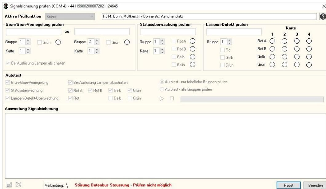
Jedes Testergebnis (Rückmeldung ob die Signalsicherung auslöst oder nicht) der aktuell ausgeführten Prüfung wird dann im Feld „**Auswertung Signalsicherung**“ eingetragen. Der Inhalt der Ergebnisliste kann zur Dokumentation in eine Datei gespeichert, ausgedruckt und wieder aus der Datei geladen werden.
