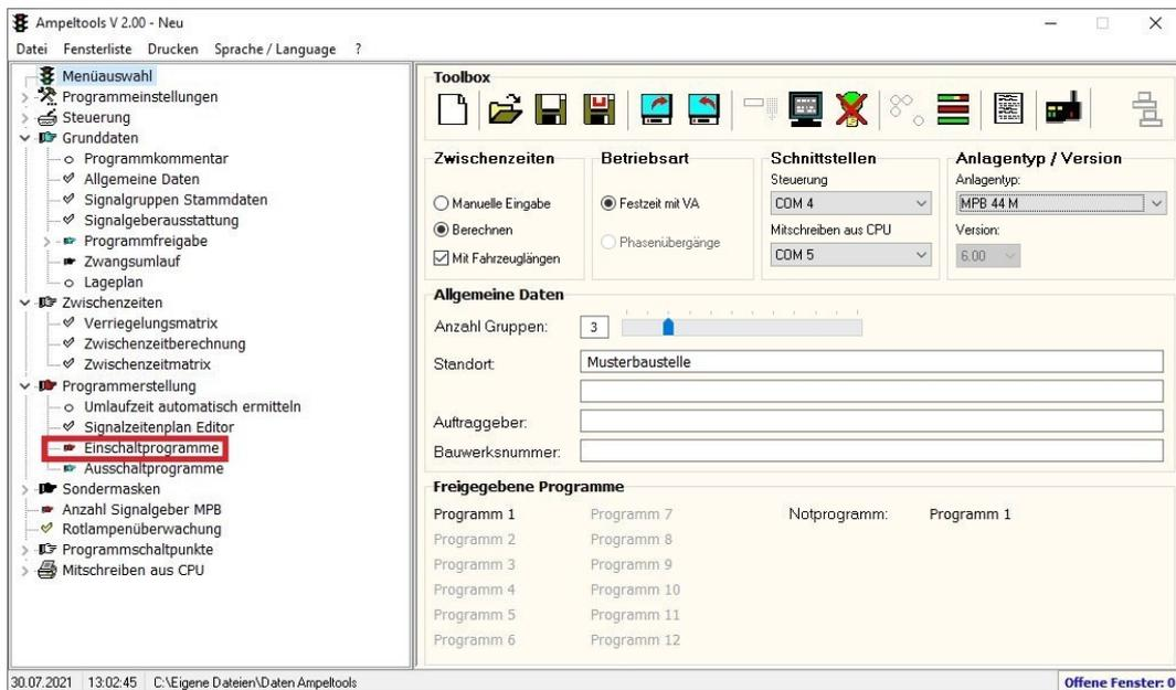
Geben Sie bitte bei Schrittdauer für Schritt 1 den Wert „5“ ein. Bei Schritt 2 tragen Sie das Ergebnis ein, welches sich ergibt, wenn man von „**Höchste Zwischenzeit aus Matrix**“ die fünf Sekunden aus dem ersten Schritt abzieht. (Im Umkehrschluss ergibt die Addition der Werte aus Schritt 1 und 2, den Betrag, der unter „**Höchste Zwischenzeit aus Matrix**“ angegeben ist.) Der dritte Schritt bleibt leer.
