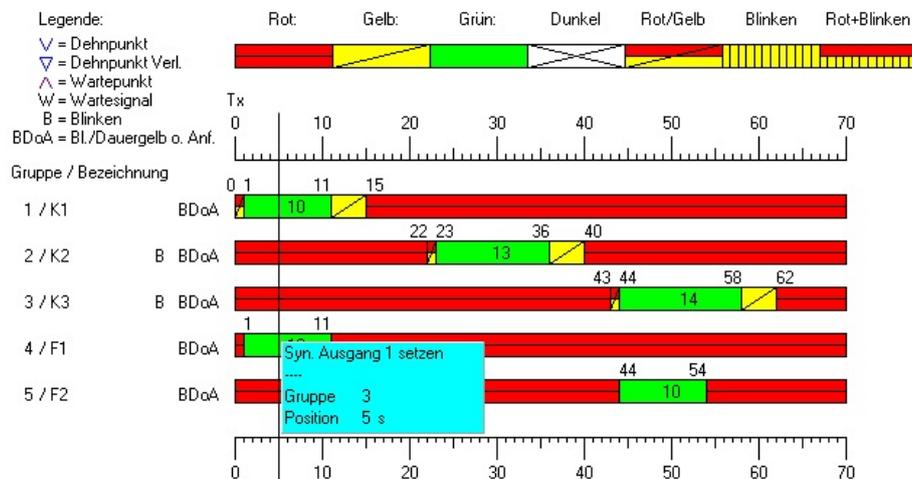
Bei Anlagen vom Typ EPB 12 / EPB 24 / EPB 48 ist die Dauer des Synchronimpulses frei einstellbar (Anlagenfunktionen), bei allen anderen Geräten der EPB Baureihe beträgt diese fest 2 Sekunden. Ab Version 6.50 (EPB 12 / EPB 24 / EPB 48) kann die Wirkungsweise der Synausgänge in den Anlagenfunktionen verändert werden. ☞ **6.9.1.2**
