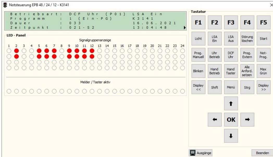
Über die Maske kann eine Notbedienung der Steuerung erfolgen, falls am Steuergerät die Bedienung durch einen Defekt nicht mehr möglich ist.
