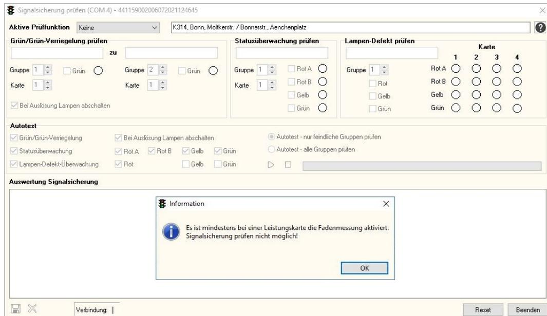
Wird die Hinweismeldung bestätigt, so wird das Fenster „**Signalsicherung prüfen**“ geschlossen, da eine Prüfung ist nur bei eingeschalteter LED-Messung möglich ist.
