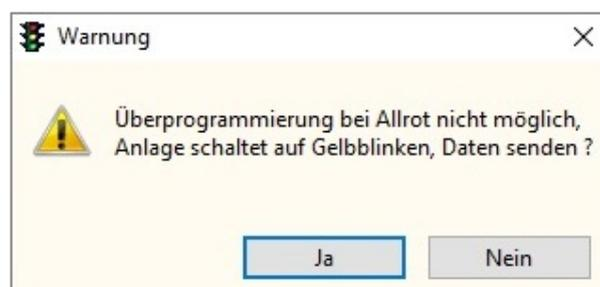
Wird diese Abfrage mit „Ja“ bestätigt, erfolgt die Datenübertragung zur Steuerung. Diese schaltet dann aber, wie angekündigt, auf Gelbblinken. Bei „Nein“ wird der Vorgang abgebrochen.
