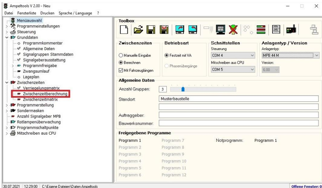
Bitte geben Sie die erforderlichen Daten für die Zwischenzeitberechnung je Räumvorgang ein. Die Berechnungsparameter werden aus den Signalgruppenstammdaten vorge setzt, können aber je Räumvorgang angepasst werden.
