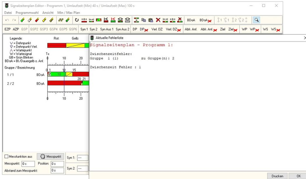
Zusätzlich erscheint noch eine Hinweisliste, die sämtliche Zwischenzeitfehler – mit Angabe in welchem Programm, den betreffenden Gruppen sowie der zugehörigen Signalgruppenbezeichnung – anzeigt. Über die Schaltfläche „**Drucken**“ werden die angezeigten Fehler über den am PC angeschlossenen Drucker ausgegeben.
