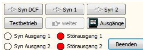
Über die Schaltflächen „**Syn DCF**“, „**Syn 1**“ und „**Syn 2**“ werden die entsprechenden Syneingänge für die Grüne Welle simuliert.
