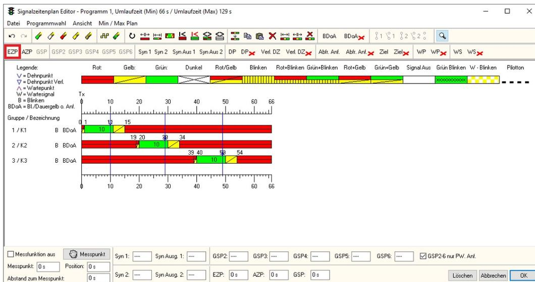
Markieren Sie den gewünschten Einschaltzeitpunkt durch einen Mausklick in die gewünschte Sekunde des Umlaufs. Im Regelfall liegt dieser immer in einem Allrotpunkt im Signalzeitenplan, direkt vor Rotgelb einer Signalgruppe – im Beispiel ist es die Sekunde Null.
