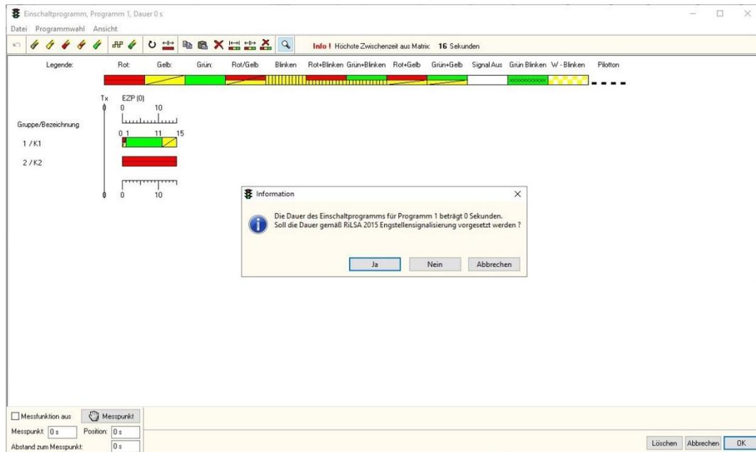
Wird diese Abfrage mit „**Ja**“ bestätigt, so werden die Werte gemäß RiLSA 2015 Engstellensignalisierung vorge setzt. Die Gesamtdauer beträgt dann 4 Sekunden (Gelb KFZ) zuzüglich dem Wert der längsten Zwischenzeit.
