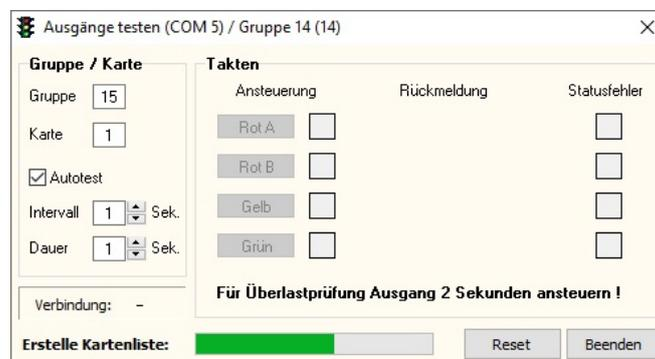
Ist diese Funktion aktiv, werden alle anderen Bedienelemente gesperrt. Bei Gruppe (Karte nur bei EPB 24 / EPB 48) wird angezeigt, welche Gruppe gerade angesteuert wird – zur Kontrolle des Ausgangs leuchtet die entsprechende Ansteuerungsleuchte.
