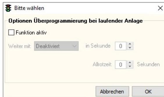
Wird diese Funktion nicht aktiviert, schaltet die Steuerung während der Programmierung auf Gelbblinken, entsprechend der letzten Programmierung.
