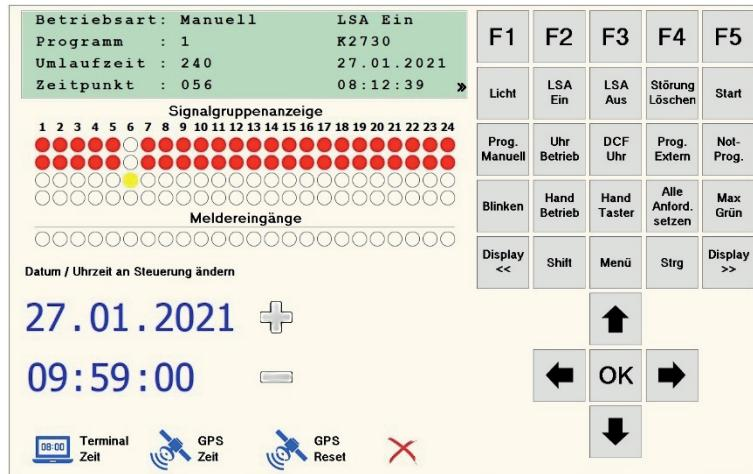
In dieser können zu Testzwecken bzw. zur Korrektur (Datum / Uhrzeit in der Steuerung falsch) das Datum und die Uhrzeit in der Steuerung verändert werden.
