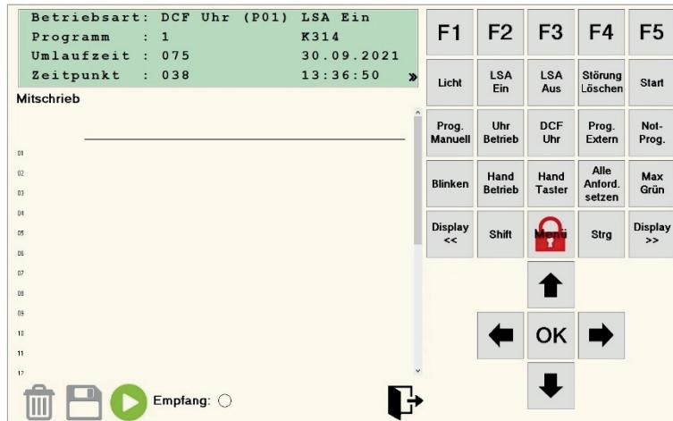
In dieser Maske kann ein Mitschrieb (Aufzeichnung eines laufenden Programms) erzeugt und gespeichert werden.
