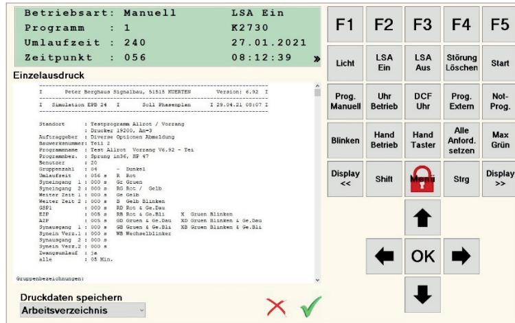
Wird die Schaltfläche mit dem grünen Haken angewählt, werden die aktuellen Druckdaten auf dem gewählten Ziellaufwerk gespeichert.
