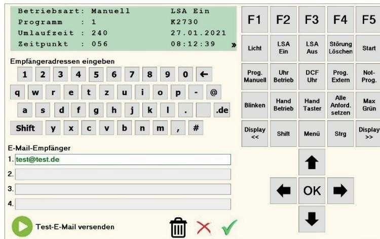
Sobald in einem Adressfeld eine Eingabe erfolgt, wird der Text im jeweiligen schwarz gefärbt. Die Schaltfläche „**Test-E-Mail versenden**“ wird freigegeben, sobald in einem Adressfeld eine Eingabe erfolgt bzw. in einem Feld bereits eine Empfängeradresse vorhanden ist.
