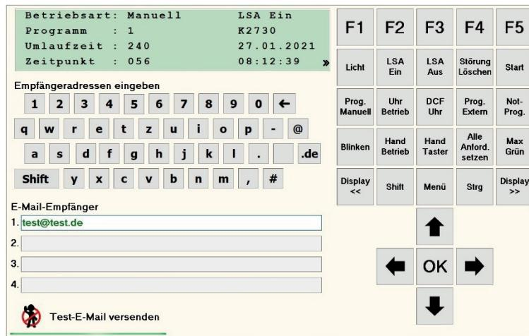
Wurde kein Testversand durchgeführt, werden alle vorhandenen E-Mail-Adressen rot markiert. Ein Versand von E-Mails ist ohne durchgeführten Testversand nicht möglich!
