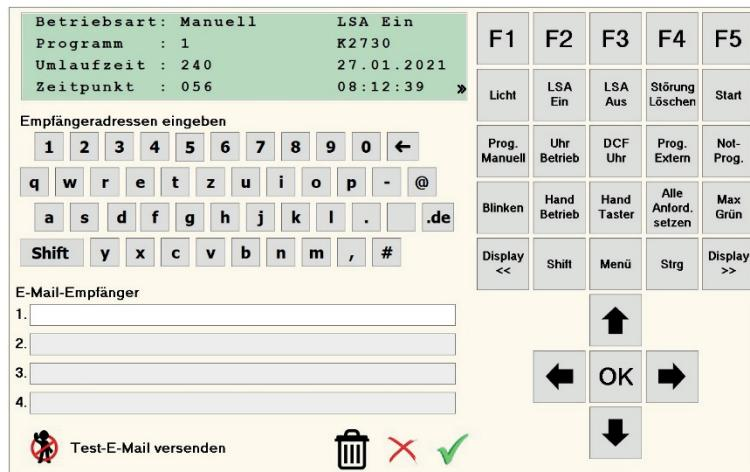
Werden Empfängeradressen eingegeben, so werden diese grün markiert, wenn bereits ein Testversand durchgeführt wurde. Ist noch kein Test erfolgt, sind sie schwarz markiert.
