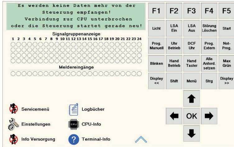
Solle diese Fehlermeldung erscheinen, ist die Verbindung zur Steuerschnittstelle der CPU gestört. Die Schnittstelle für die Display- und Signalgruppenanzeige funktioniert jedoch einwandfrei und eine Bedienung der Steuerung über Bedientastatur ist möglich.
