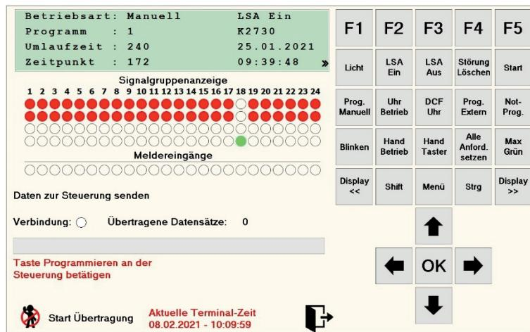
Damit eine Übertragung möglich ist, müssen Sie den Programmiertaster in der Frontplatte der Steuerung betätigen. Die Schaltfläche „**Start Übertragung**“ wird für fünf Sekunden freigegeben. Nach Ablauf dieser Zeit wird die Schaltfläche wieder gesperrt und eine erneute Freigabe ist erforderlich.
