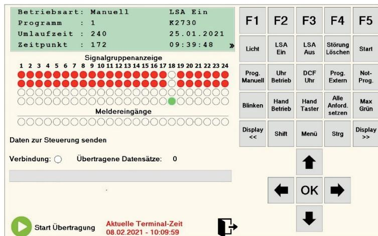
Durch Betätigung der Schaltfläche „**Start Übertragung**“ wird der Vorgang für die Datenübertragung eingeleitet.
